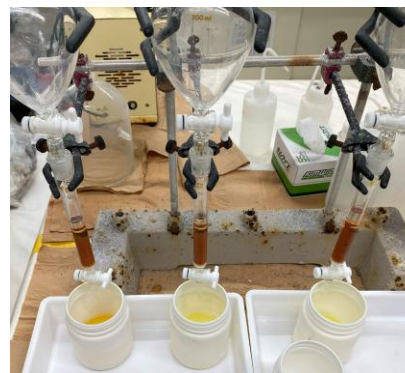
イオン交換法 (イオン交換樹脂によるカラム分離)
