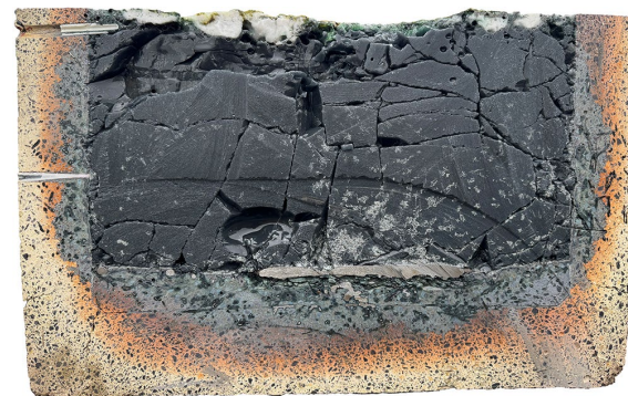
溶融17 ガラス固化体断面
