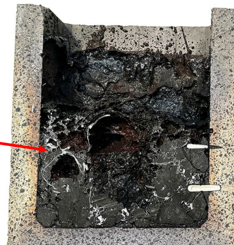
ベンチ規模試験1B ガラス固化体断面
