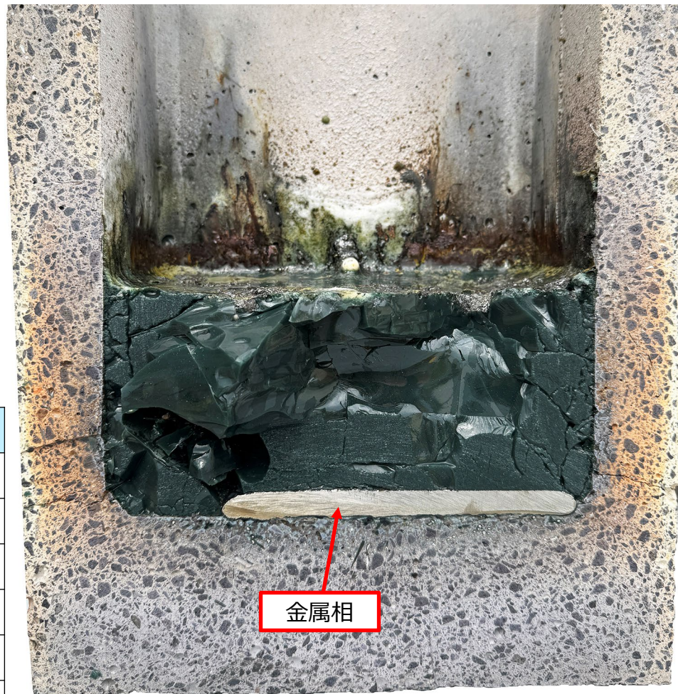
ベンチ規模試験2 ガラス固化体断面
