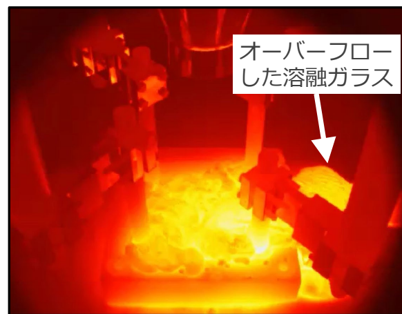
ベンチ規模試験1A オーバーフロー発生時の炉内状況
