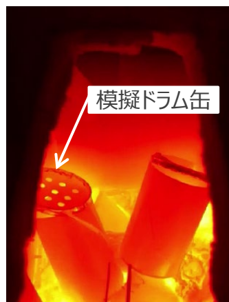
溶融ガラス表面 の模擬ドラム缶
