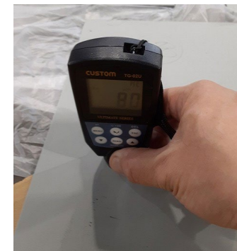
過去試験時の膜厚測定（参考）
