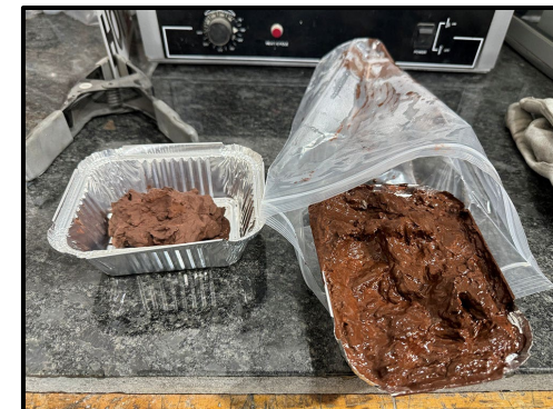
乾燥後のALPS鉄共沈スラリー脱水物 (左)
