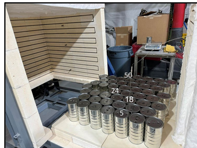
電気乾燥炉で加熱する脱水物容器
