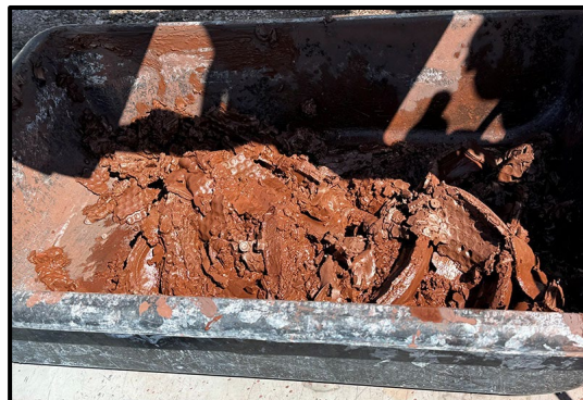
模擬ALPS鉄共沈スラリー脱水物 (含水率35wt%)
