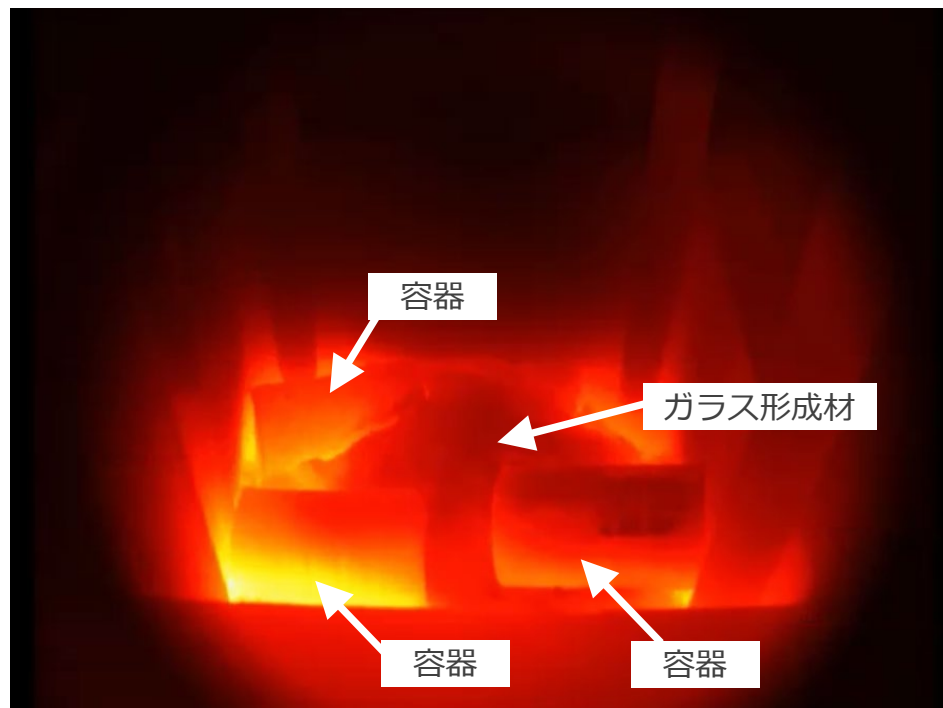
溶融18の炉内の状況
