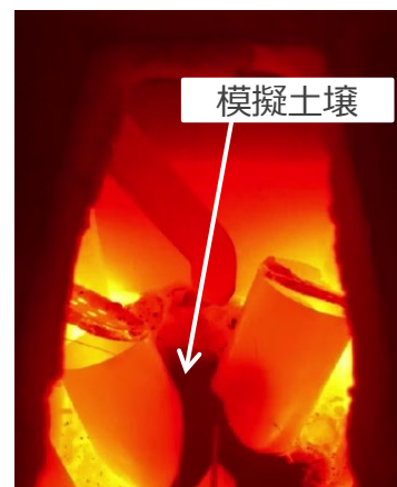
追加の模擬土壌および 炭酸ナトリウムの供給
