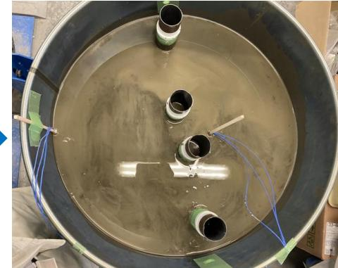
セメントキャップの打設を完了。
