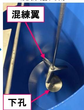
混練槽に混練溶液を投入
