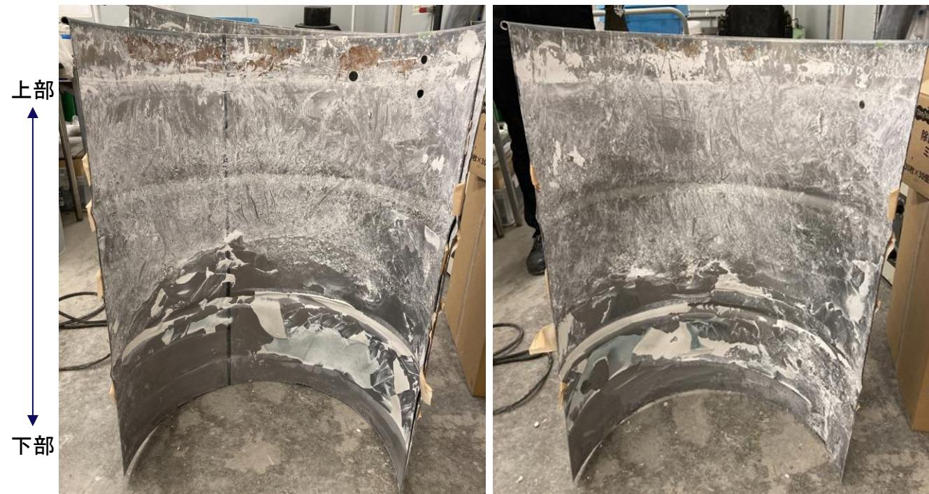
ドラム缶の内側面の内、AAM系均質固化体に触れていた箇所は全く錆びていなかった。
