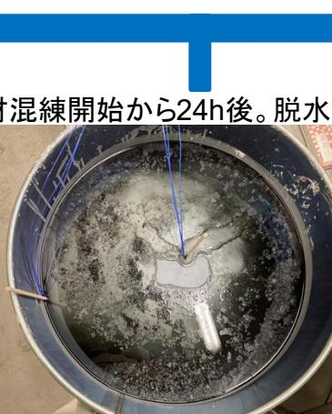
充填材混練開始から24h後。脱水縮合による浮き水の発生(厚さ約2mm)
