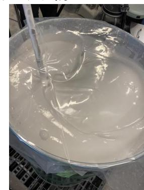
その後、気泡を減らすために低速で約10min混練。
