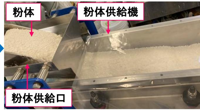
混練槽に母材粉体を投入していく
