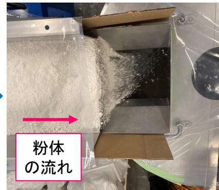
全粉体を投入後、高速で約15min混練。
