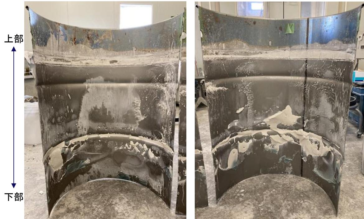
ドラム缶の内側面の内、AAM系均質固化体に触れていた箇所は全く錆びていなかった。
