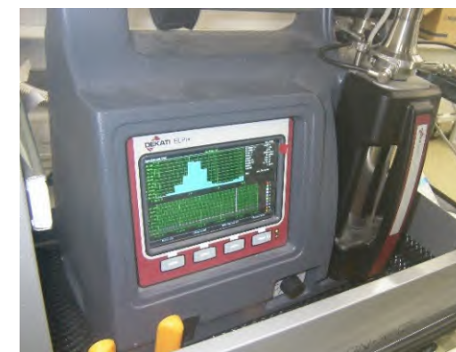
ELPI+(空気動力学径測定、 粒径範囲は0.01～10μm )
