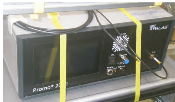
Palas社のWelas2000(左)とPromo2000(右)※ (光散乱径測定、 粒径範囲は0.2～40μm )
