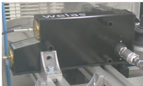
Palas社のWelas2000(左)とPromo2000(右)※ (光散乱径測定、 粒径範囲は0.2～40μm )
