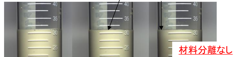
図2 ブリーディングの状態(左:AAM+ジルコニア15 \mu m, 左:AAM+ジルコン500 \mu m)
