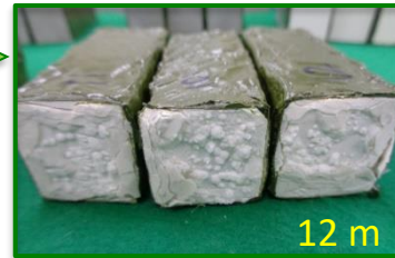
図2 AAM(M)固化体の暴露面の状況(加速条件)
