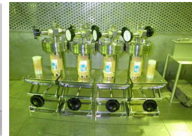
図3 気密性照射容器と照射試験の様子
