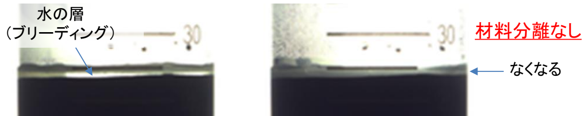
図1 OPC+硫酸バリウムCのブリーディングの状態(左:1 h, 右:24 h)
