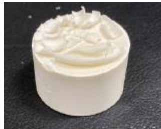
図1 AAM固化体の鱗片化の様子
