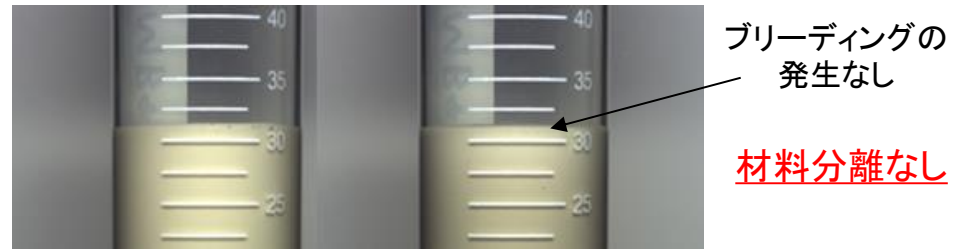
図1 AAM+硫酸バリウムCのブリーディングの状態(左:0h, 右:24h)
