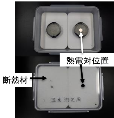
図1 断熱材を用いた温度測定の様子
