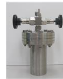
図3 気密性照射容器と照射試験の様子
