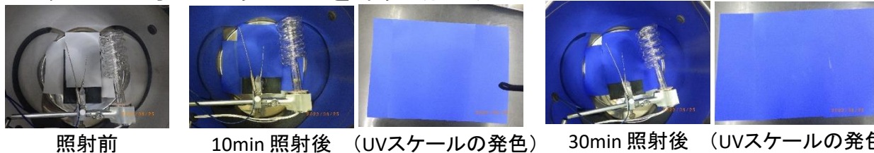
図3 UVスケールによる装置内のUV光量分布確認
