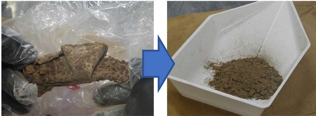
試料表面を研磨し、粉体として回収
