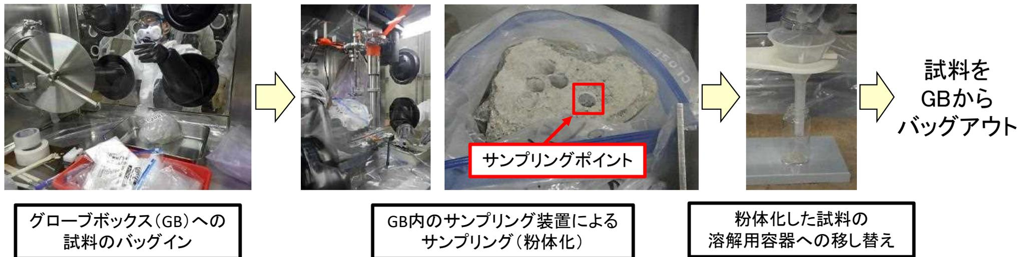
図36 サンプルング装置を用いた粉体化の流れ
