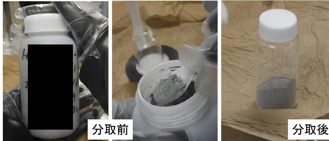
図29 焼却灰試料の分取作業の様子
