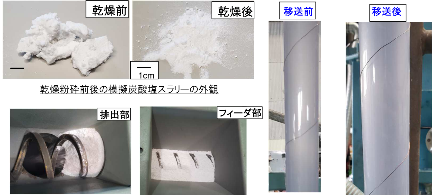
無軸スクリーフィーダ移送試験(模擬炭酸塩スラリー: 定量供給) 移送試験前後アクリル配管部の様子
