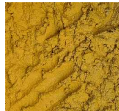
試験に用いるキレート樹脂外観 (樹脂にFeを吸着させ, FeOOHと混合した状態)
