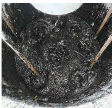
実用規模CCIM内で ガラスが固化した様子
