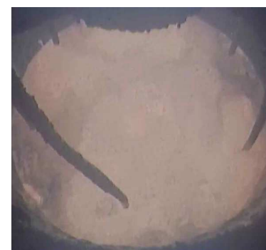
再加熱により炉内ガラスが 溶融した状態
