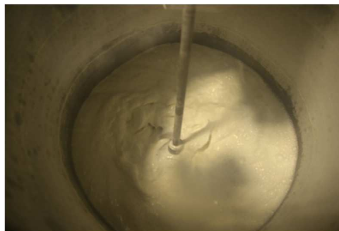
模擬炭酸塩スラリー (タンク内で攪拌している様子)
