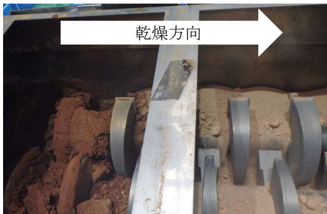
試験中のドライヤ内の様子
