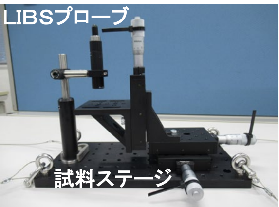
ホットセルに持ち込んだLIBS計測系 (マニピュレーターによるマイクロメータ操作)
