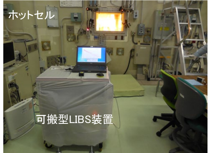
ホットセル前に持ち込んだ可搬型LIBS装置 (20mの光ファイバーをセル内に導入)
