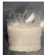
←AAMの白華現象(写真:例)。 \text{Na}_2\text{CO}_3 を主成分とする結晶が固化体から析出。
