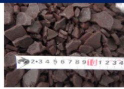
鉄共沈スラリー
