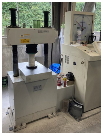
固化体を設置
