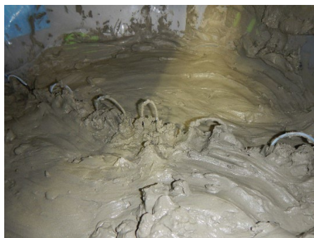
混練開始から 70分 。 充填完了。指が刺さらないほど硬化。
