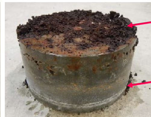
塊状ISの沈殿
