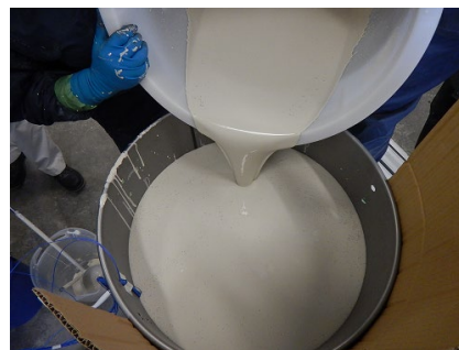
30分で打設終了。 この時の内部温度は室温+5℃。
