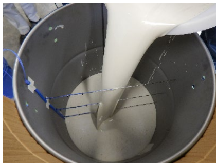
ドラム缶にM+BFS+CSを打設。極めて高流動。 (熱電対に当たって液流が分離するほど流動性が高い。)
