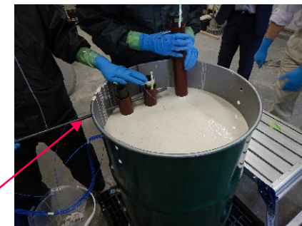
固化体が巨大で通常のコア抜きは不可。 未硬化時に筒*を挿入する方式でコア抜き。
