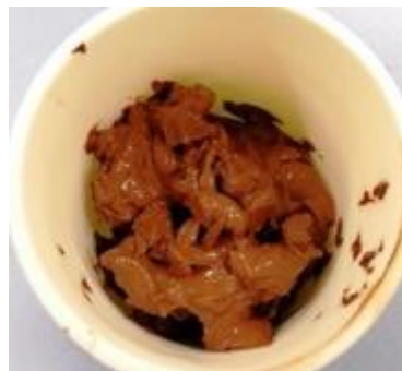
{模擬スラリー1 (炭酸塩 + 鉄共沈) + ガラスフリット}混合物 ガラス固化 体量で100g程度 熱処理前
