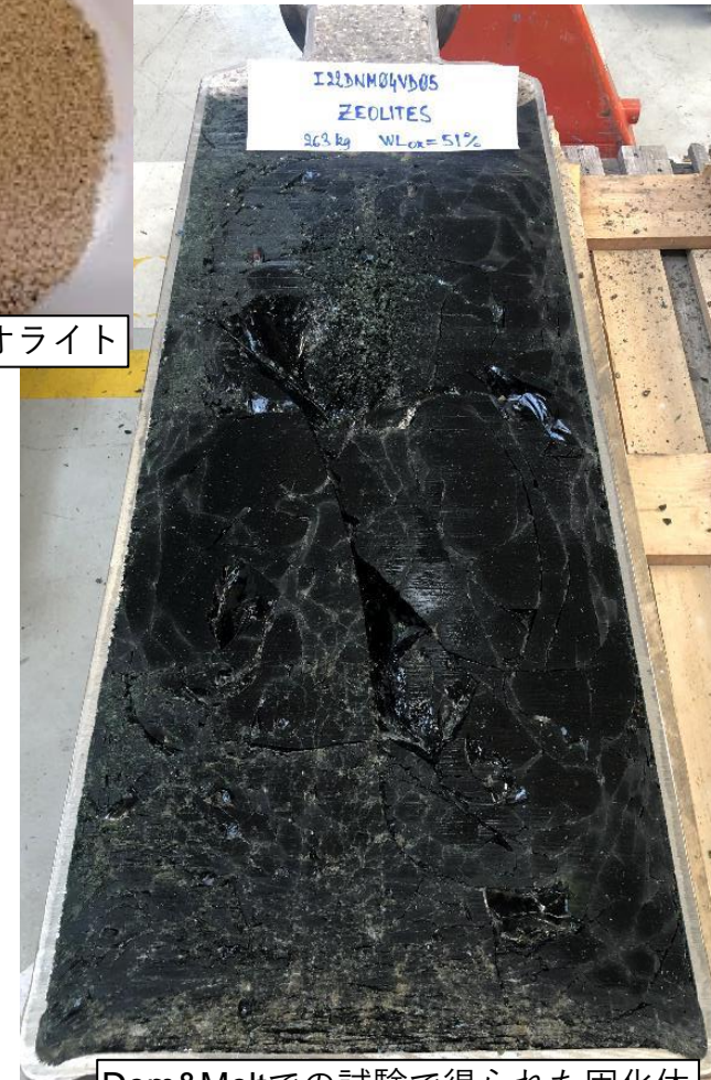
Dem&Meltでの試験で得られた固化体
