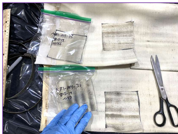
Cs及びSr分析用のバグハウスバッグサンプリング
