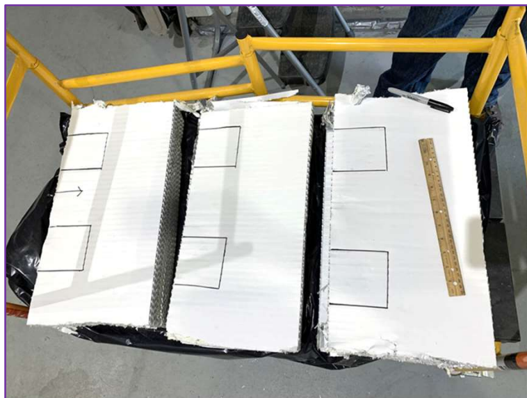
Cs及びSr分析用のHEPAフィルタサンプリング
