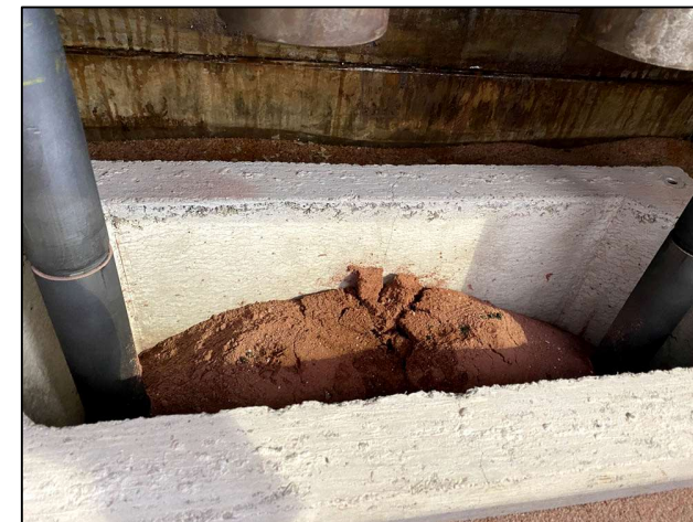
緊急停止を模擬した溶融炉の上部表面を示す画像。試験計画に従って溶融完了前に中断したため、未溶融の試験材料が確認できる。
