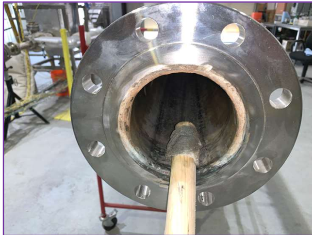
Cs及びSr分析用の配管拭き取りサンプリング
