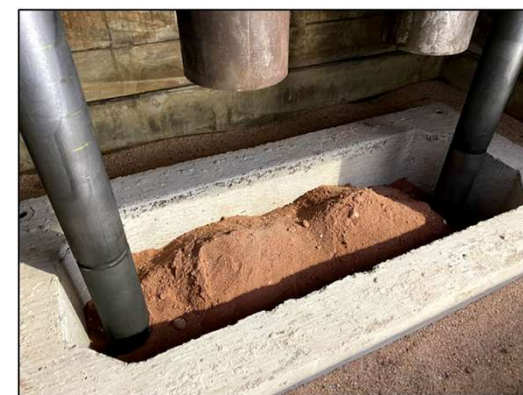
80 kgの試験材料、供給配管、電極及び耐火物容器を設置した溶融炉の外観
