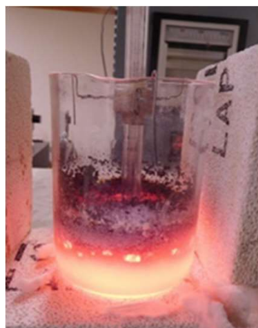
加熱後に取り出した石英ビーカーの状態(溶融試験5の材料)
