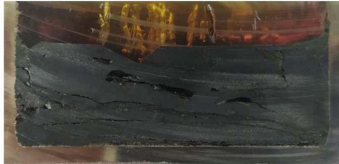
ベンチスケール試験で作製された ALPSスラリーガラス固化体
