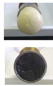
図6 PCV上部止水用止水試験状況
