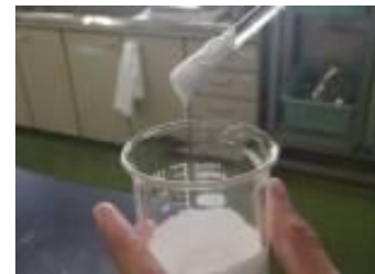
図2 非溶解性吸収材試作例 (ガドリニア・スラリー)
