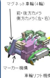
図1 S/C下部外面調査装置と工場モックアップ試験設備
