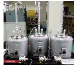
図2 長時間腐食試験の状況
