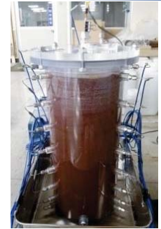
図2 セシウム吸着塔内部の状態を知るための試験用模擬カラム
