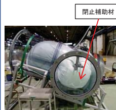
図3 ベント管止水用閉止補助材試験状況
